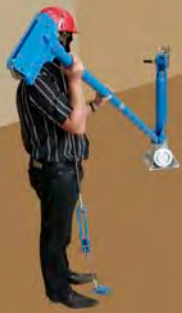
FISSAGGIO TRAMITE TRAZIONE DEL PERNO
